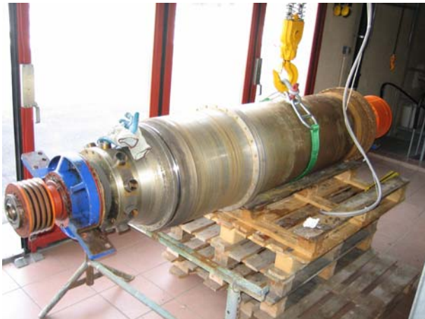
Schnecke beim Ausbau
