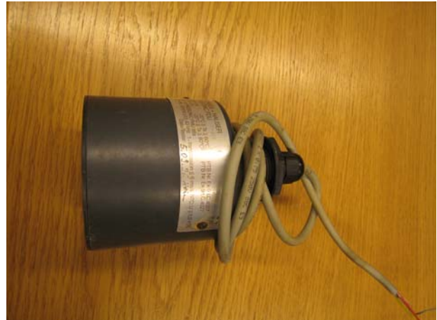
alte Niveaumessung Stapelraum
